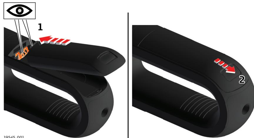
1. Fixer la partie supérieure de la batterie dans un coin du compartiment, puis abaisser la partie inférieure.
