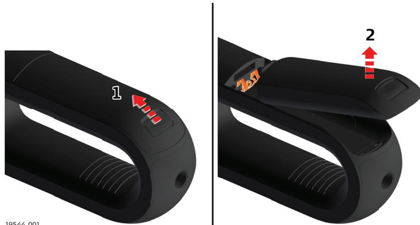
1. Faire glisser le mécanisme de verrouillage de la batterie en position ouverte.
