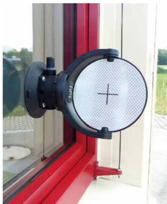
Marquage SLAM RSL452M* sur ventouse RSSV-X90. Peut aussi être utilisé avec scanner RIEGL.
