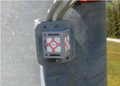
Repère sur pylône remonte-pente
