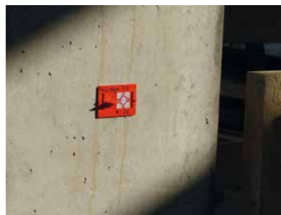
RS30r dans la construction de bâtiments industriels : un point de mesure parfait pour chaque instrument de mesure.
